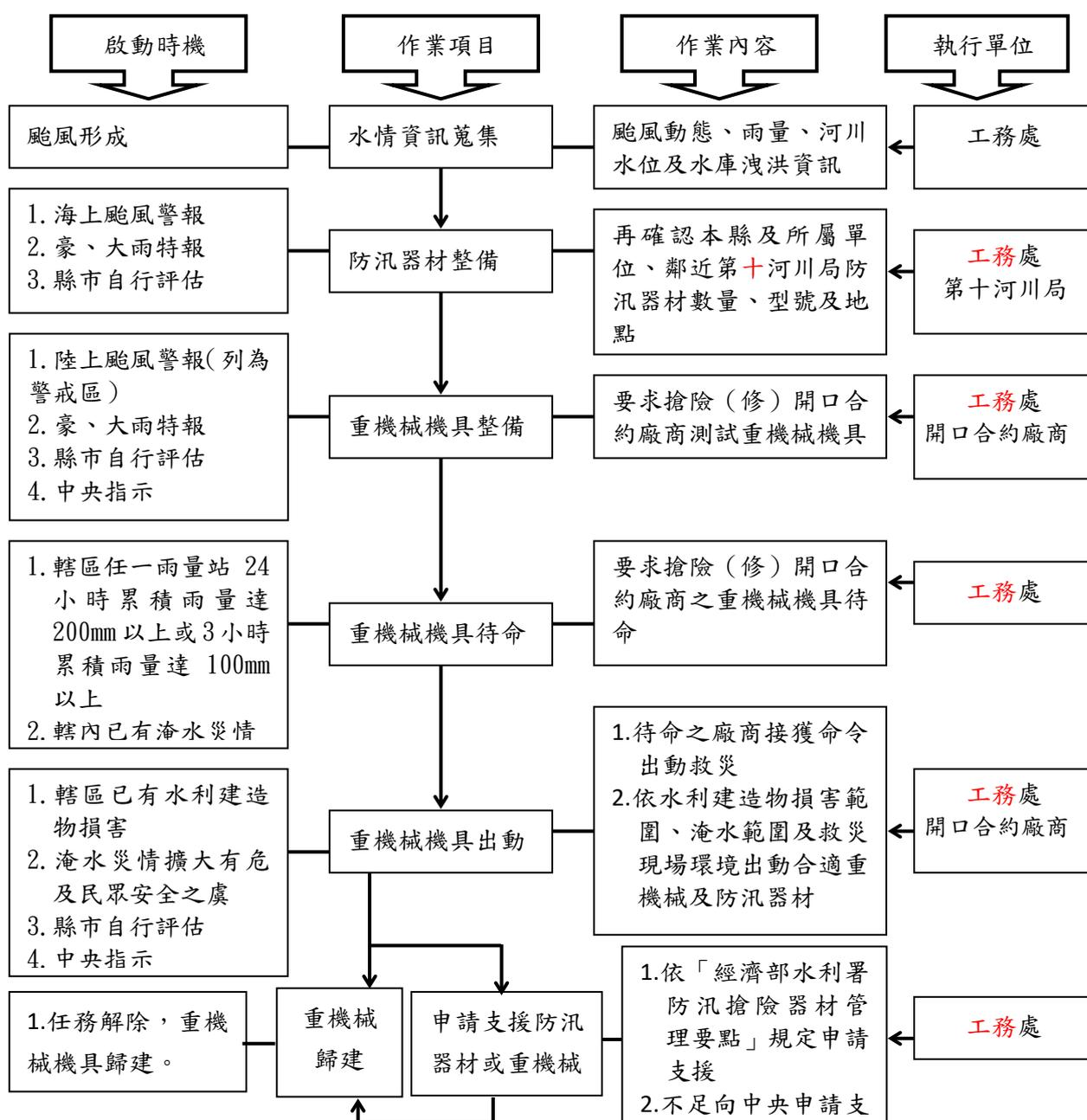
圖 3-2 防汛器材運用流程圖
